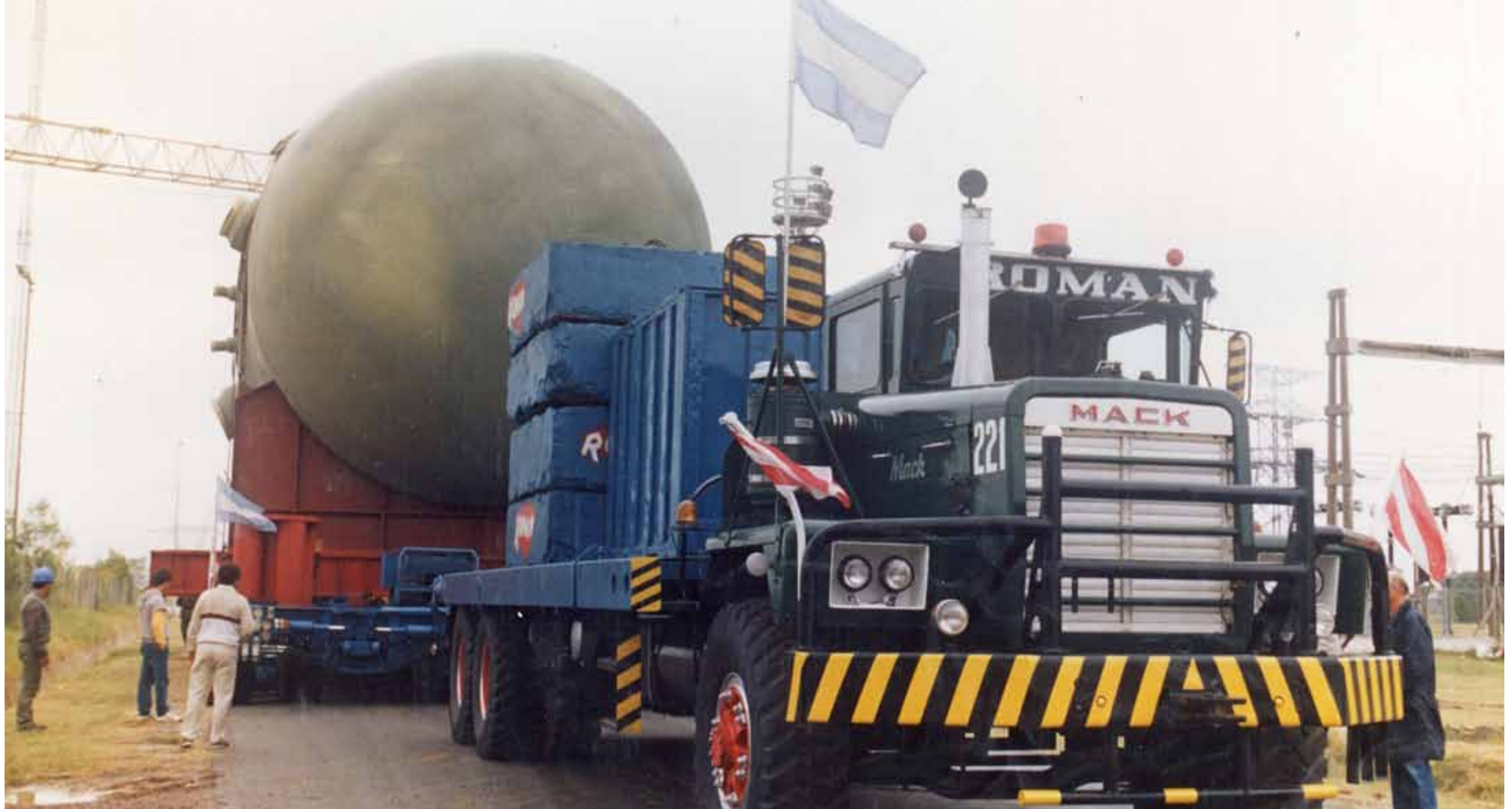
TRASLADO DEL REACTOR NUCLEAR DE 870 TONELADAS CON CARRETÓN MODULAR DE 240 RUEDAS EN CENTRAL NUCLEAR ATUCHA II. ENACE S.A.
